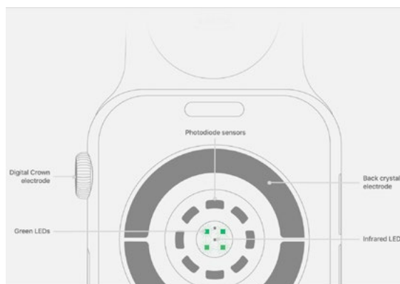
Figura 2. Rappresentazione schematica dei sensori PPG e degli elettrodi ECG – proprietà di Apple Inc. Schematic representation of PPG sensors and ECG electrodes - property of Apple Inc.
