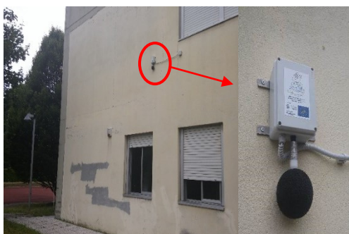
Figura 3 – Esempio di installazione di un SSMR in facciata ad un edificio.
