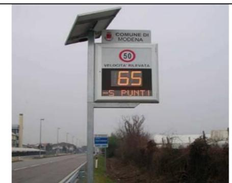
Figura: Immagine indicativa di un dissuasore di velocità
