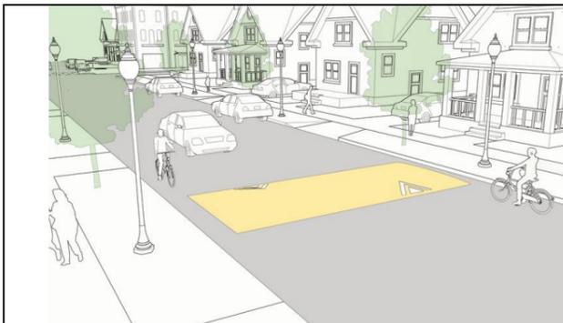
Figura: Illustrazione di un dosso rallentatore
