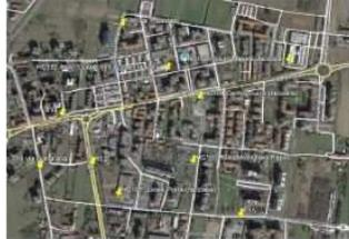
In particolare, sono state installate 10 stazioni di monitoraggio nel quartiere Libertà: 3 microfoni sono stati collocati lungo Viale Libertà, la strada principale dove si prevede che il mix dei flussi di traffico sarà sostanzialmente modificato, a seguito della netta diminuzione dei mezzi pesanti, passando dallo scenario ante a quello post-operam, mentre gli altri microfoni sono stati distribuiti uniformemente lungo le strade che ricadono all'interno dell'area pilota.
